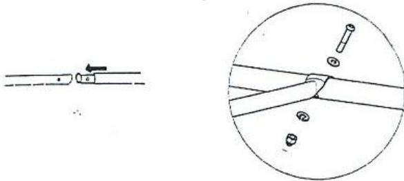
3.-9 Прикрепите нижнюю опорную трубку (NN) к поперечине (MM) с помощью болта (K), шайбы (H), пружинной шайбы (F) и глухой гайки (J).
