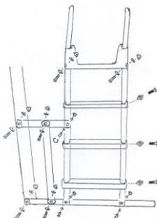
3.-7 Соедините поперечины (LL) и (MM) с помощью болта (JJ), шайбы (H), пружинной шайбы (F) и глухой гайки (J).
